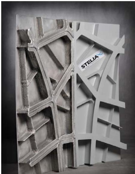
**Démonstrateur de panneaux de fuselage imprimé en 3D**
