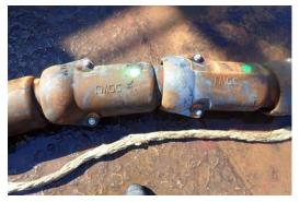
Les coquilles développées par FMGC protègent, stabilisent et limitent la courbure des câbles électriques sous-marins. L'objectif des essais est de démontrer la stabilité des câbles lestés avec ces coquilles en fonte, y compris lors de conditions de houles importantes. Les coquilles resteront donc plusieurs mois sur le site et devront subir les conditions extrêmes de l'hiver. Ces essais seront également l'occasion de comparaisons, puisque des tronçons de câbles tests, 2
