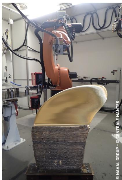
par dépôt et non de la soustraire par usinage. En levant des limites imposées par les procédés traditionnels, ces technologies ouvrent la voie à des concepts de pièces et d'assemblages novateurs, et donc à la production de propulseurs apportant une plus grande efficacité aux navires en mer : performances (autonomie et rendement propulsif), furtivité et allègement.
